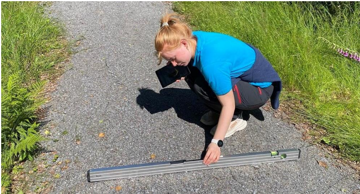
Figur 27: VATER: Måling av tverrfall med et digitalt vater. Foto: Inger-Marie Juel Gulliksen, Oslofjordens Friluftsråd.
